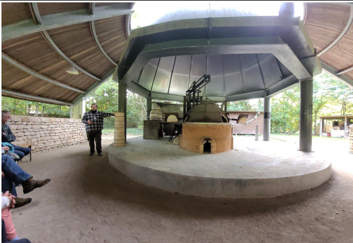
Four destiné à la séparation de l'Argent et du Plomb
