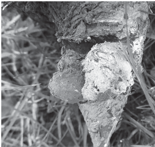
▲ Photo 4. La couleur « vert pistache » visible sur la tarière est caractéristique de la formation de l'argile verte de Romainville dans cette zone. (source : CJR Audits).
