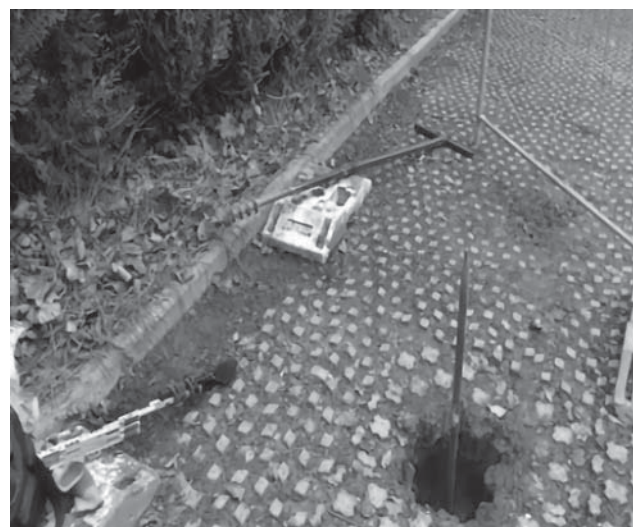
▲ Photo 13. Dissolution de gypse dans une copropriété (source : CJR Audits).
